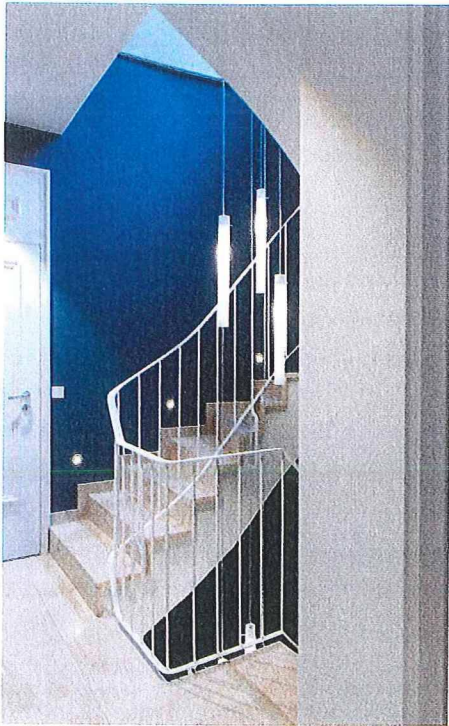
Eine Lichtinstallation erstreckt sich über alle Stockwerke des Treppenhauses. Zylinder aus opalweißem Glas erhellen das Treppenauge und sind ein schöner Kontrast zu dem Petrol-Ton „Skater“, der Räumen eine faszinierende Tiefe und Ausdruck verleiht. Lichtspots in Fußhöhe der Stufen sorgen für Trittsicherheit.
